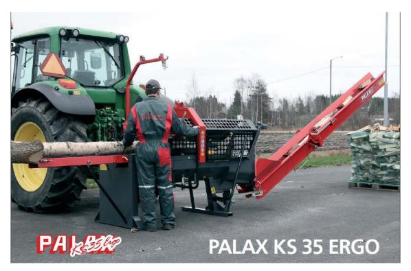
KS35 ERGO は近代的な操作のしやすい薪割り機です。15"チェーンソーがついています。オペレータの骨盤の辺りにあり、横に動く玉切り用ハンドルによって、従来行っていた上下運動をしなくてすみ、作業時の労働性が格段に良くなっています。長さ 2.2 m、幅 27cm の送材コンベア、長さ 4.3m のスイング可能折りたたみ荷積み用コンベア、自動注油のチェーンソーが標準でついています。処理する木の大きさがまちまちの場合、この機械はとても効率的です。最大直径 35cm の処理が可能です。
