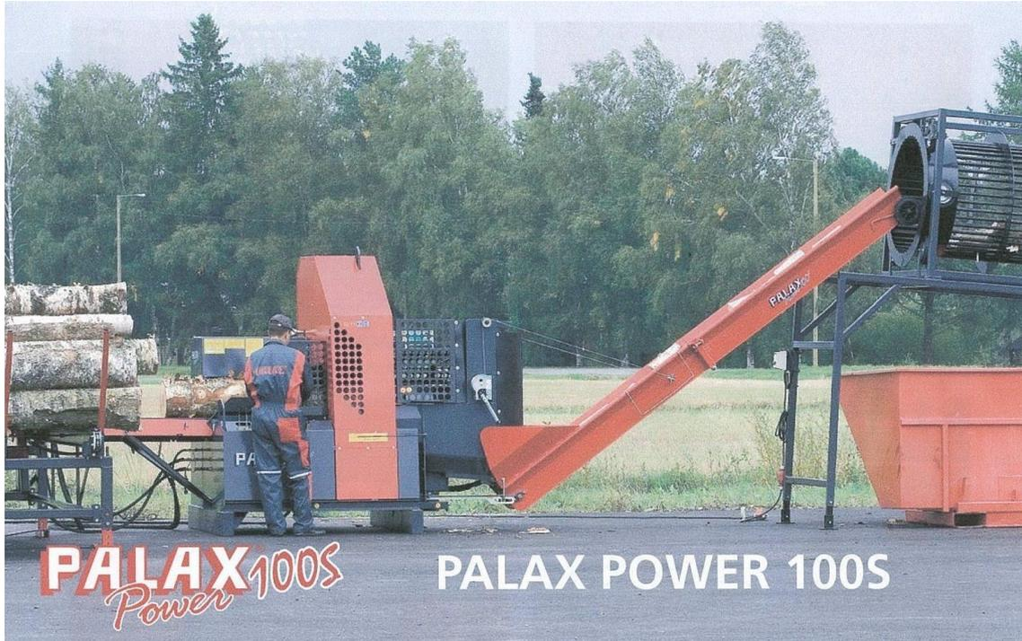
いくつかの特徴と仕様をもつ Palax Power 100s 薪割り機は、業務用に設計されました。大きい木を扱えるサイズの機械の中では、Power 100s は最も効率がよく生産性の高い、最も信頼できる機械です。この機械は標準装備として、薪割りシリンダーの自動高速バルブを持っています。高速シリンダーによって発生した割材する力が十分であれば、そのまま薪を割ることができます。割材する力が足りない場合、シリンダーの大きさによりますが、さらに 10 か 16 トンの力が加えられます。薪割りが始まり、割材する力が十分になると、高速薪割りが自動的に再開されます。この高速薪割りには、小さい木の場合スピードを、大きい木の場合割材する力を与えます。
